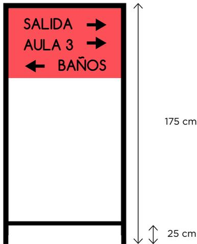
Si no se prolongan hasta el suelo se colocará una barra horizontal entre sus patas a una altura máxima de 25 cm, su color contrastará con el entorno y sus elementos serán romos.
