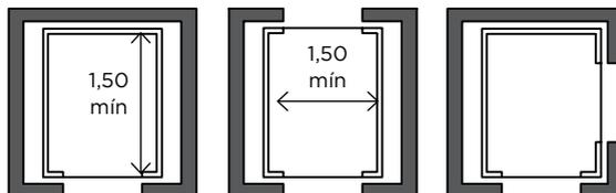
**TIPO 2-B:** 1,30 m x 1,73 m, que **permiten girar 360° en tres maniobras**; con puerta sobre lado mayor, próxima a una de las esquinas de ña cabina o con puerta sobre lado menor.
